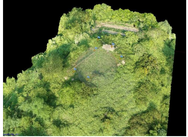
Fig. 19 - Restituzione della mesh tridimensionale dell'area rilevata con applicata la texture fotografica ottenuta (Elaborazione M. Tremari).
