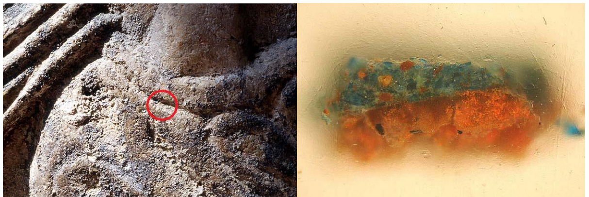
Fig. 23 A sinistra, particolare dell'abito dell'angelo e dell'area analizzata (lastra frontale). A destra, sezione stratigrafica dell'azzurro posto sulla bordura della veste: base rossa composta da minio, cinabro, biacca e ocre; pellicola pittorica azzurra composta da azzurrite, biacca e ocre.
