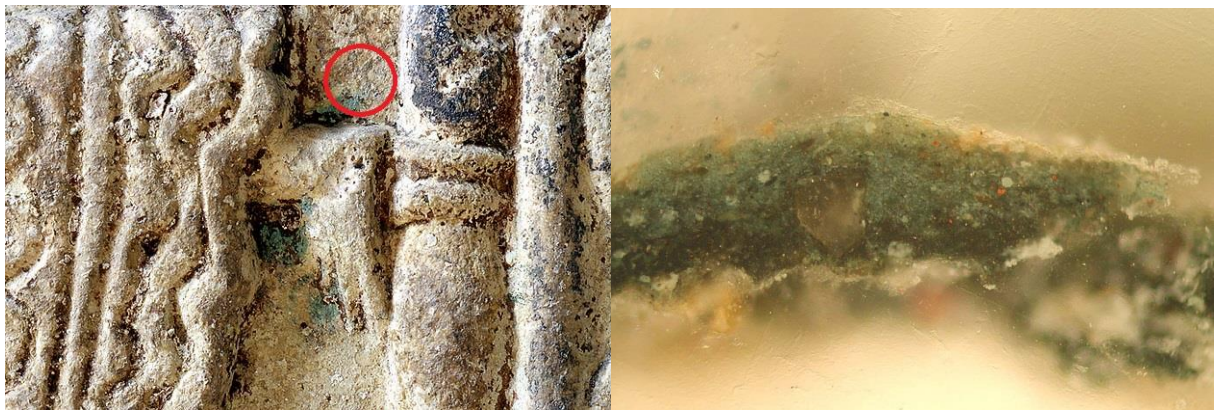
Fig. 22 A sinistra, particolare del cielo e dell'area analizzata (lastra frontale). A destra, sezione stratigrafica dell'azzurro del cielo: fondo di biacca; base di azzurro-blu composta da biacca, indaco, nero vegetale, silicati e ocre; pellicola pittorica azzurra composta da indaco e biacca.
