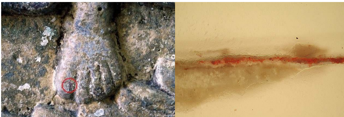
Fig. 25 A sinistra, il piede sinistro di Cristo e l'area analizzata (lastra frontale). A destra, sezione stratigrafica dell'incarnato: scialbatura a calce; incarnato composto da sola biacca; velatura a cinabro per i dettagli anatomici.
